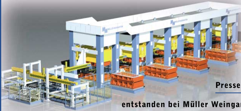
Hydraulische Hochleistungs- presse mit Linearfeder.
