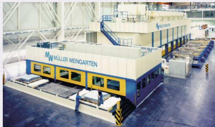
Großteil-Saugertransferpresse für großflächige Karosserieteile.
