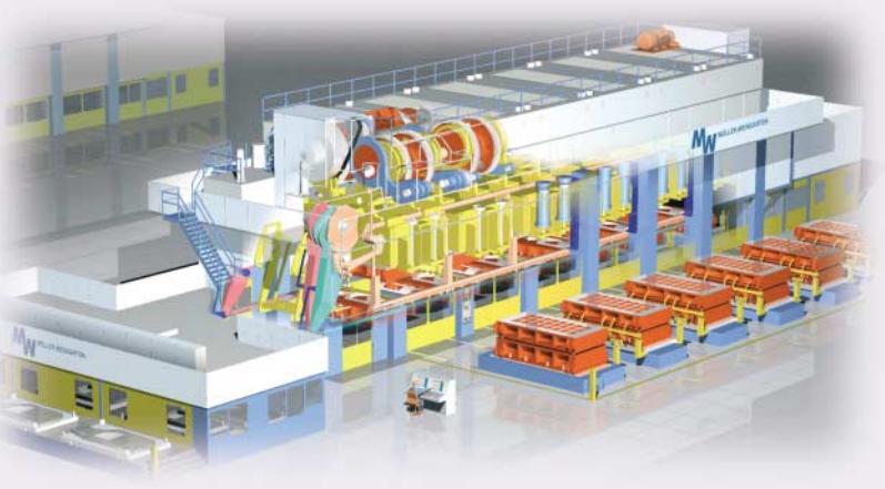
Virtual Reality: Großteil-Saugertransferpresse mit 95.000 kN Preßkraft für großflächige Karosserieteile.
